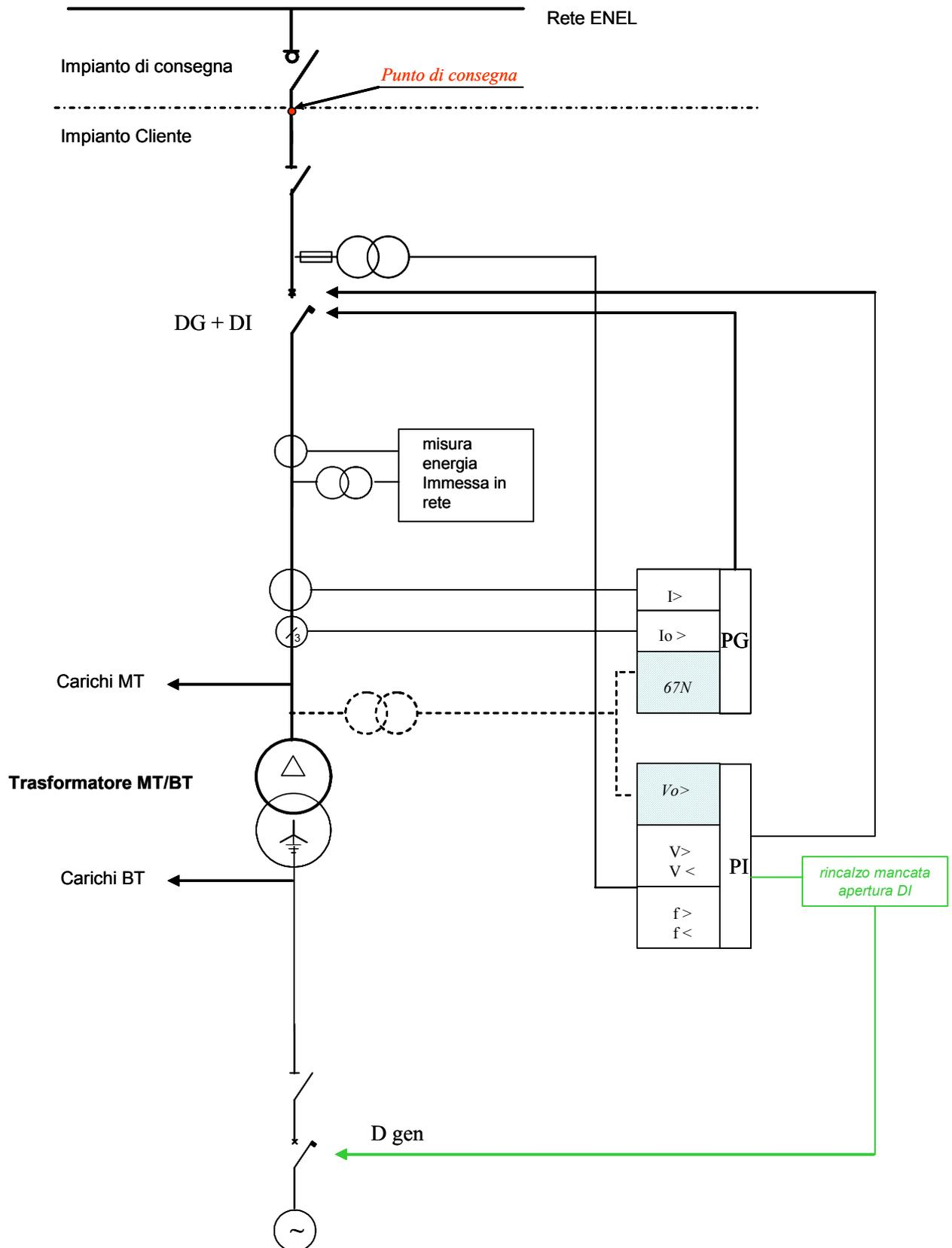
**Fig. 4 - Schema tipico di collegamento di impianti di produzione alla rete MT ENEL (con Dispositivo Generale con funzione anche di Dispositivo di Interfaccia)**
